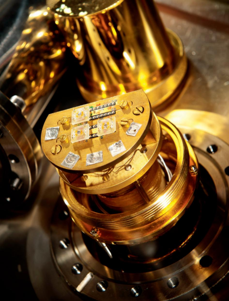
Das große Potenzial solcher thermoelektrischer Generatoren wird in einer einfachen Rechnung klar: Wenn nur zehn Prozent der deutschen Pkw-Flotte, also rund fünf Millionen Autos, mit einem thermoelektrischen Generator ausgerüstet würden, der ein Kilowatt elektrische Leistung erzeugt, und wenn jeder dieser Generatoren 200 Stunden pro Jahr aktiv wäre, ließen sich 100 Millionen Liter Treibstoff sparen.
