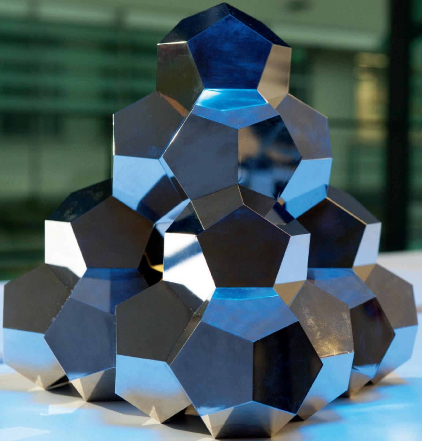
Kandidat für ein effizientes Thermoelektrikum: In dem Modell ist die Gerüststruktur intermetallischer Clathrate zu erkennen. An den Ecken der Polyeder sitzt jeweils ein Atom, die Hohlräume in ihrem Innern bieten weiteren Atomen Platz. In solchen Materialien kann eine elektrische Spannung entstehen, wenn sie einem Temperaturgefälle ausgesetzt sind.
