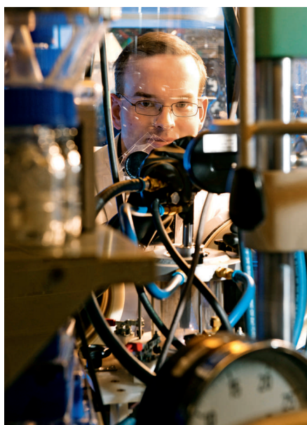
Neue Verbindungen erzeugt Bodo Böhme oft im Lichtbogenofen (links). Doch er und seine Kollegen testen auch andere Synthesemethoden (rechts): Hier präsentiert Böhme einen Probenbehälter, in dem die pulverförmigen Ausgangsstoffe liegen. Sie werden von einem Gas überströmt und reagieren zu der Zielverbindung.
