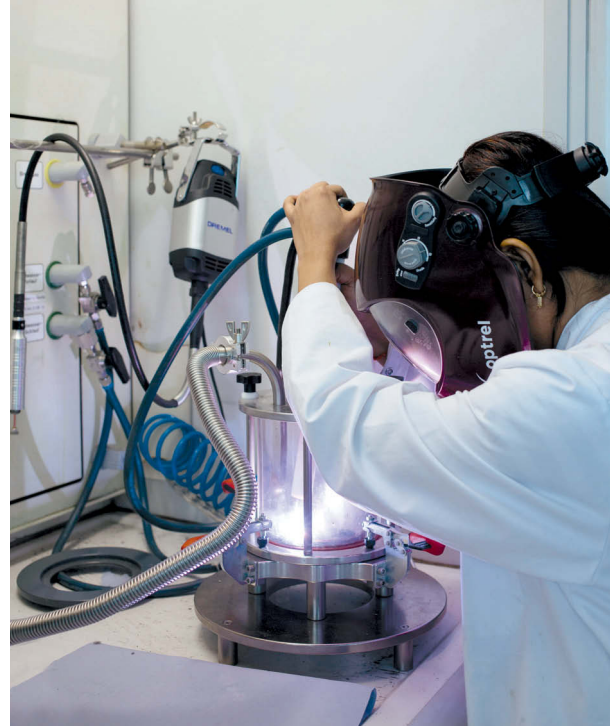
Erst rechnen, dann backen: Binghai Yan (links) simuliert die Eigenschaften von Materialien erst mit Modellen und gibt den Experimentatoren Hinweise, welche Elemente sie etwa im Lichtbogenofen kombinieren sollen (rechts).
