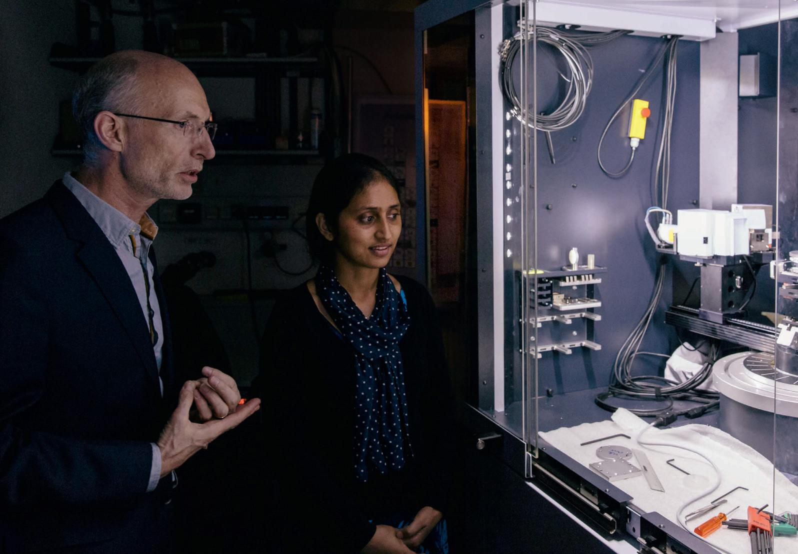
Oben: Stuart Parkin und Kumari Gaurav Rana diskutieren Untersuchungen mit einem Röntgendiffraktometer. Damit lässt sich die detaillierte Struktur von Materialschichten analysieren, wie Stuart Parkin sie auch in Halle erforschen wird.
