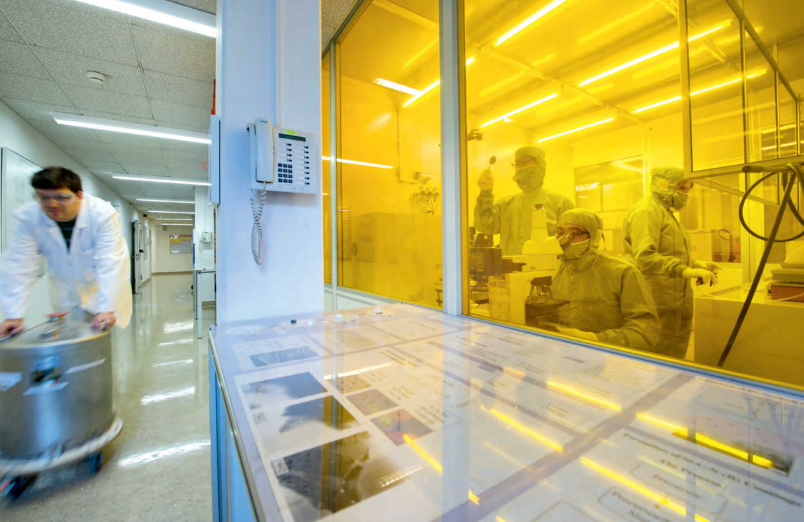
Staub stört: Im Reinraumlabor stellen die Forscher mithilfe der Fotolithografie Mikrostrukturen wie etwa eine Mikromuschel her. Dabei müssen sie selbst kleinste Verunreinigungen aus der Luft vermeiden.
