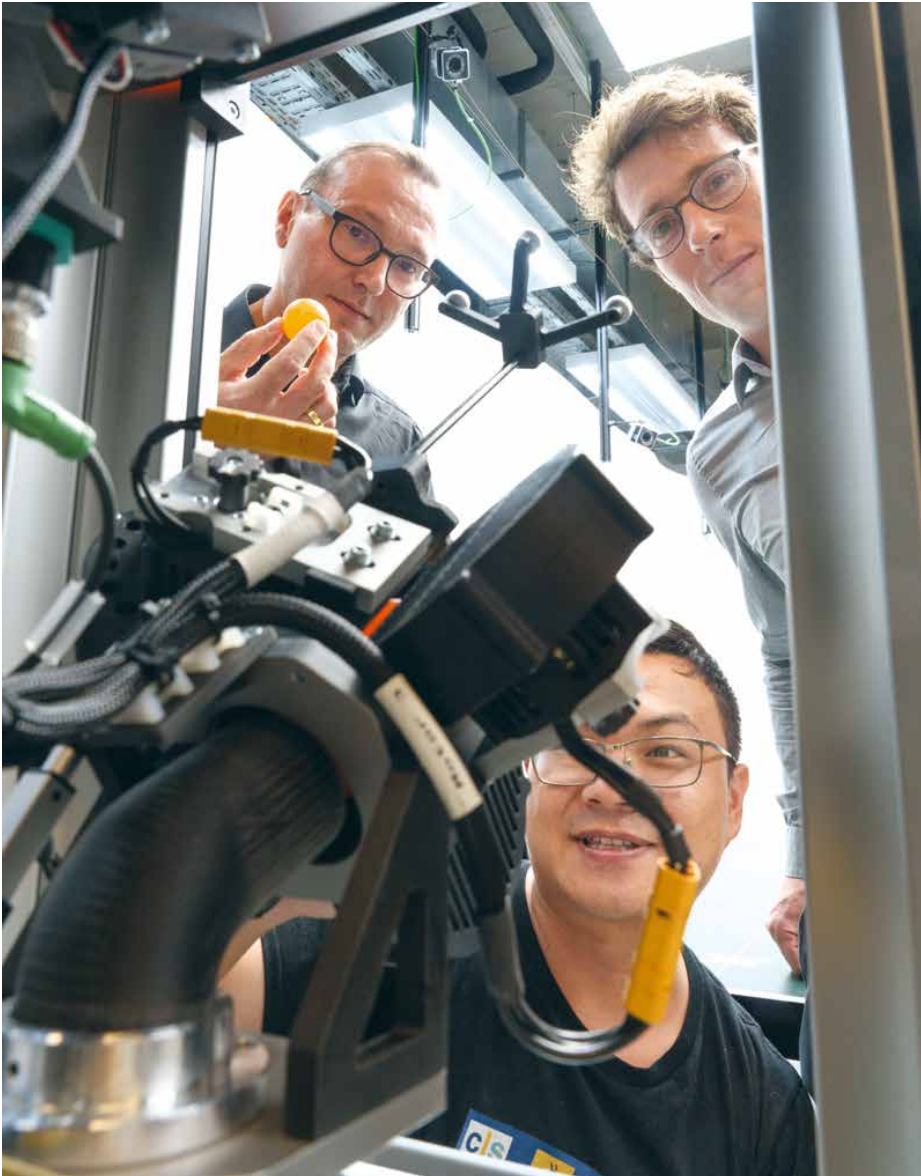
Man muss den Gegner kennen: Der Tischtennisroboter, an dessen Steuerung Jörg Stückler, Hao Ma und Michael Mühlebach (von links) arbeiten, spielt gegen eine Ballmaschine. Ein Modell dieser Maschine hilft ihm, die abgefeuerten Bälle zu treffen.
