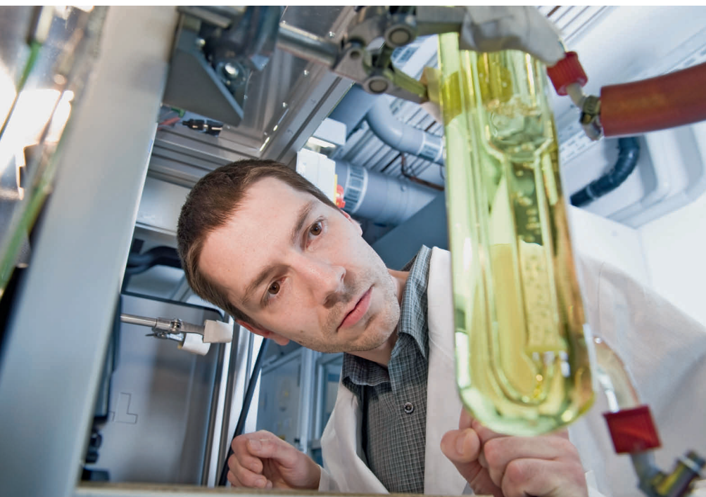
Alle Details müssen stimmen: Pierre Kube verfolgt die Tests von Katalysatoren ganz genau. Hier beobachtet er am Sättiger des Laborreaktors, wie sich ein Gas in einer Flüssigkeit löst.
