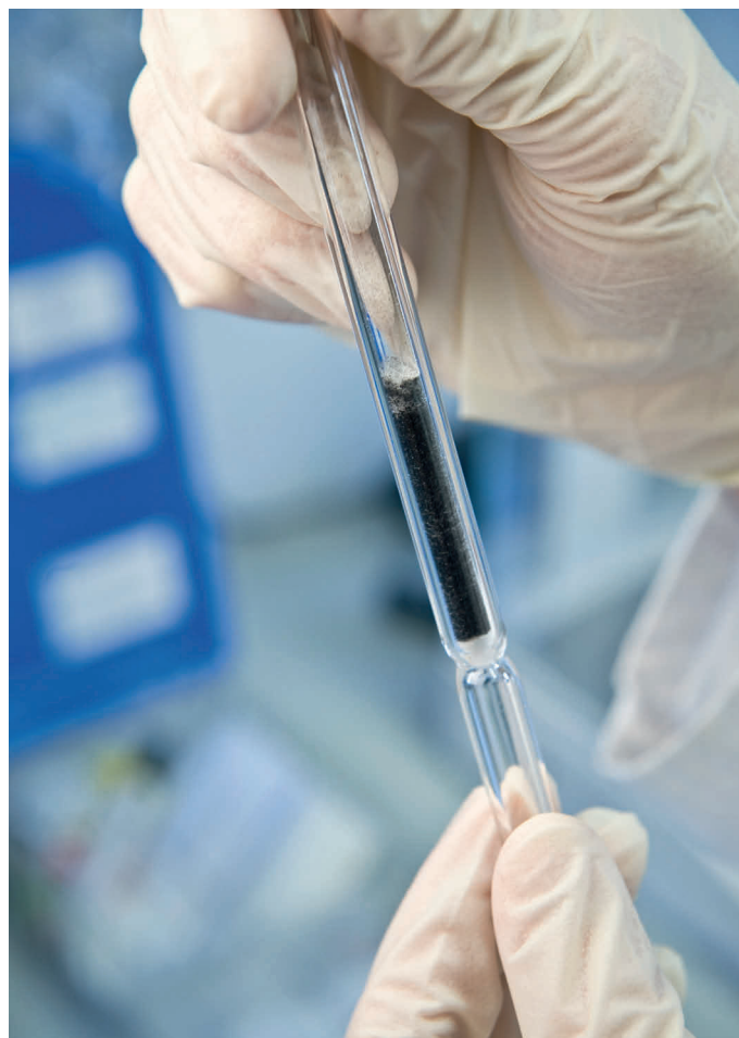
Reaktor im Labormaßstab: Kohlenstoffnanoröhrchen werden in ein Glasröhrchen gefüllt, um ihre Aktivität zu testen. Die Forscher leiten die Reaktionspartner zu diesem Zweck von der einen Seite in das Röhrchen und analysieren am anderen Ende die Produkte und die nicht umgesetzten Ausgangsstoffe.
