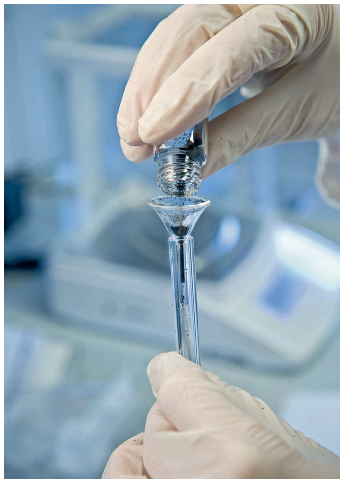
Reaktor im Labormaßstab: Kohlenstoffnanoröhrchen werden in ein Glasröhrchen gefüllt, um ihre Aktivität zu testen. Die Forscher leiten die Reaktionspartner zu diesem Zweck von der einen Seite in das Röhrchen und analysieren am anderen Ende die Produkte und die nicht umgesetzten Ausgangsstoffe.
