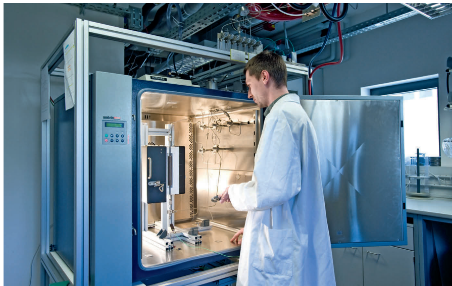
Der Laborreaktor wird gegen äußere Einflüsse gut abgeschirmt. Denn Pierre Kube muss die Bedingungen der Katalysatortests genau kontrollieren, damit sie vergleichbar sind.
