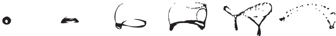
linke Seite, links: Schematische Darstellung der Wirbelschlepp hinter einem Sprühflugzeug. Die Luftwirbel entstehen infolge des Auftriebs, der an den Tragflächen erzeugt wird. Sie beeinflussen die Ausbreitung des Glyphosats.
