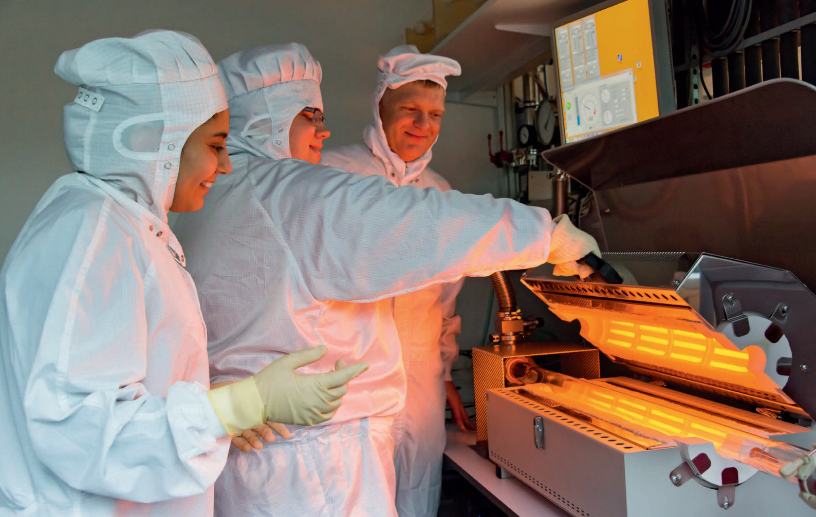
Saubere Sache: In einem Ofen scheiden Wafa Rouabeh, Patrick Herlinger und Jurgen Smet Kohlenstoff auf Metalloberflächen ab, sodass dieser Graphen bildet. Um zu aussagekräftigen und reproduzierbaren Ergebnissen zu kommen, untersuchen die Forscher das Material im Reinraum. Die Anzüge verhindern, dass sich von ihrer Kleidung Staubpartikel lösen.
