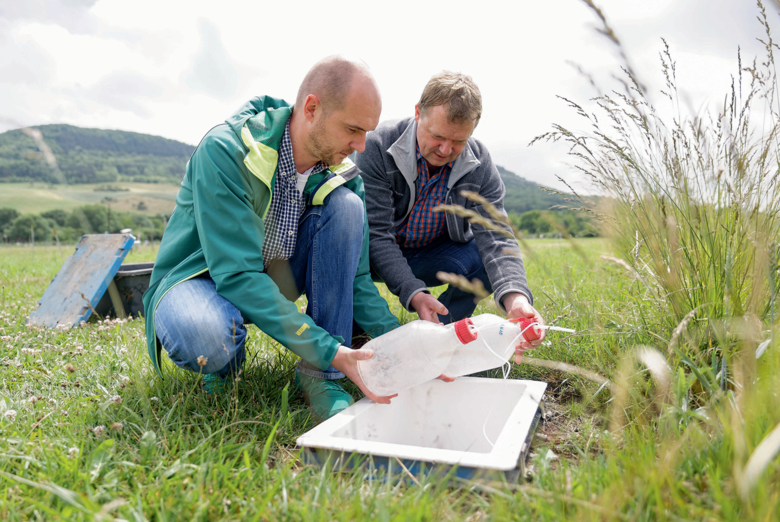
Markus Lange (links) und Gerd Gleixner analysieren die organischen Stoffe, die im Bodenwasser enthalten sind und viel über Prozesse in einem Ökosystem verraten. Das Wasser sammelt sich in Flaschen, in denen ein Unterdruck herrscht. Die Behälter stehen in einer im Boden eingelassenen Wanne.
