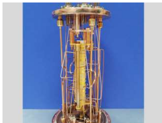
PENTATRAP consta de cinco trampas Penning dispuestas una encima de la otra (torre amarilla en el centro). En estas trampas construidas de forma idéntica, los iones en el estado cuántico excitado y en el estado fundamental pueden medirse en comparación. © IMP de Física Nuclear
