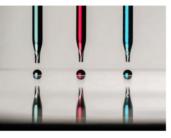
Die von SCIENION patentierte Technologie mit den Namen sciDROP PICO ist eine berührungslose Dosiertechnologie für das Microarray-Spotting.
