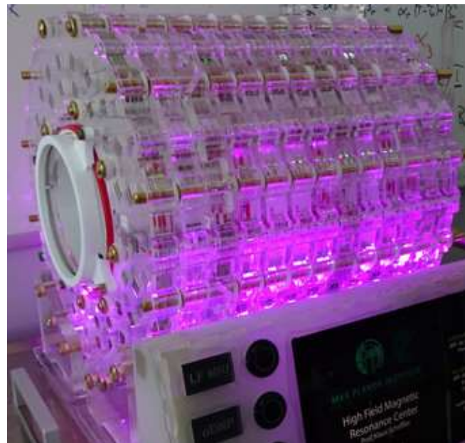
Modelo simplificado del tomógrafo de resonancia magnética de bajo campo. © Instituto Max Planck de Cibernética Biológica
