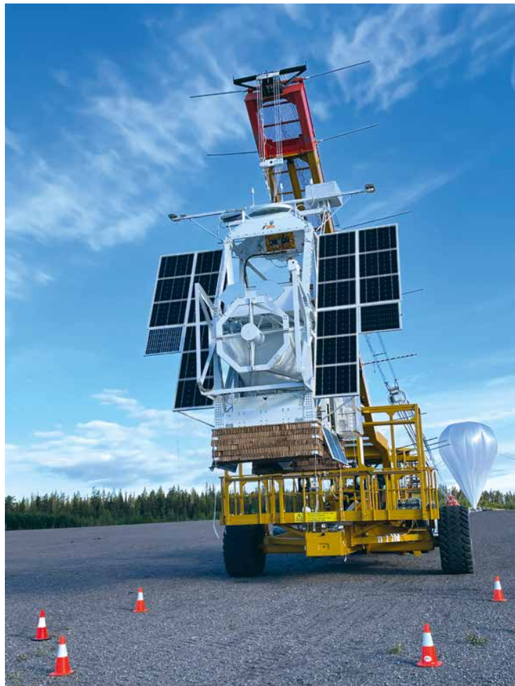
Das Observatorium Sunrise III kurz vor dem Start am Kranfahrzeug Hercules. Der riesige Ballon rechts im Hintergrund ist bereits zum Teil mit Helium befüllt. Er trägt während des Flugs eine Last von fast drei Tonnen.
