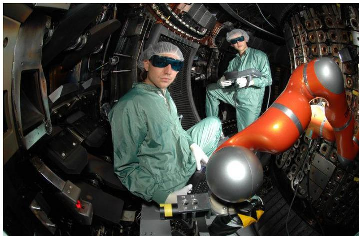
**Abb. 3:** Vermessung von Bolometer-Sichtlinien im Plasmagefäß der Garching Fusionsanlage ASDEX Upgrade mithilfe des Roboterteststandes IBOROB.
