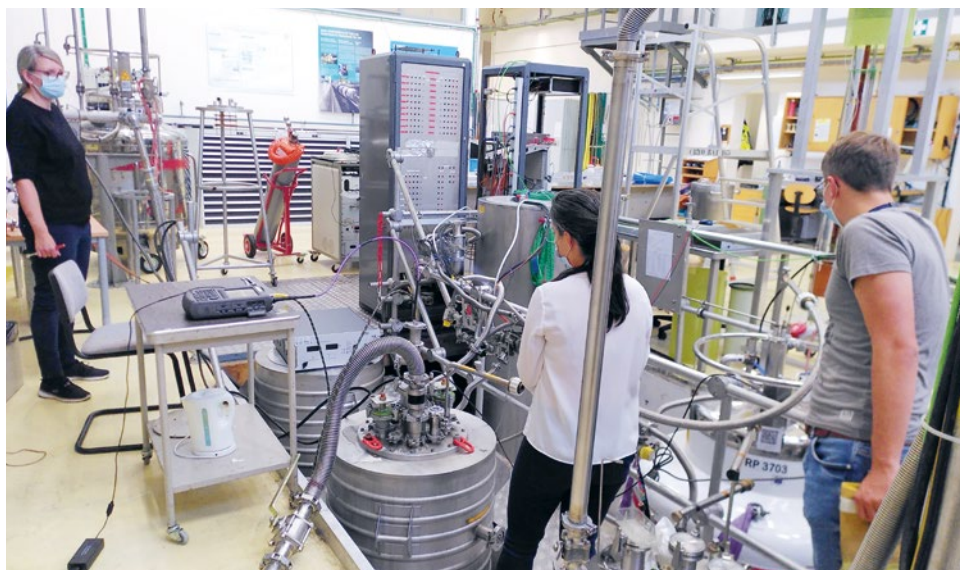
Messungen im Kryolabor des CERN mit Hochtemperatur-Supraleitern zur Suche nach Axionen.
